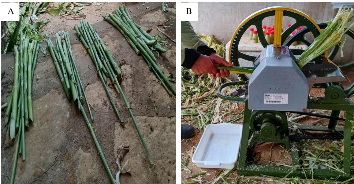
Figura 11. Separação dos colmos para moagem (A), extração do caldo do sorgo (B).
