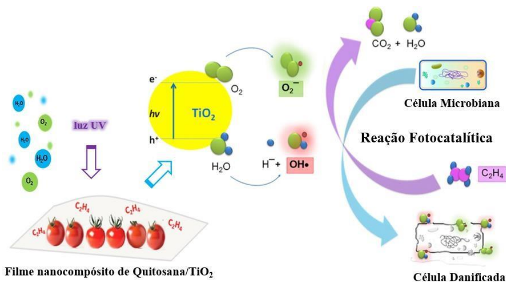
Figura 4. Diagrama esquemático do possível mecanismo da atividade antimicrobiana e da degradação fotocatalítica do etileno do filme nanocompósito de quitosana/TiO 2 quando exposto à luz ultravioleta. Fonte: (KAEWKLIN et al. , 2018; SIRIPATRAWAN; KAEWKLIN, 2018).
