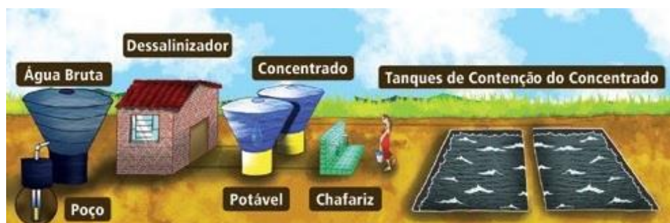
Figura 36. Esquema representativo dos sistemas de dessalinização implantados pelo Programa Água Doce – PAD.
