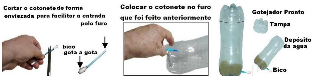
Figura 32. Etapas de montagem de um sistema de irrigação por gotejamento artesanal com cotonetes.
