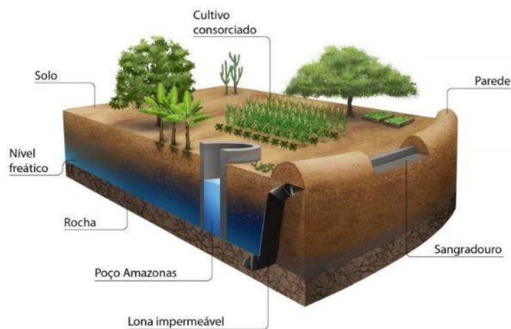
Figura 9. Desenho esquemático de uma barragem subterrânea.
