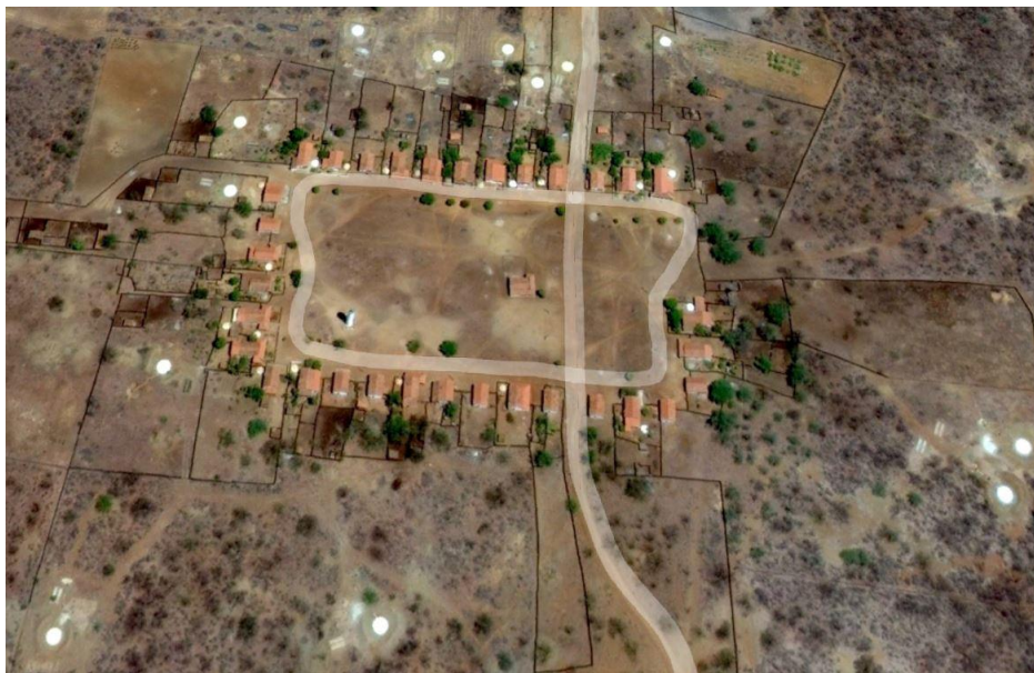
Figura 42. Distribuição das tecnologias de convivência com o semiárido no assentamento Liolândia, no município de Independência – CE: cisternas de 16.000 litros (menores e próximo das residências) e cisternas de enxurrada (maiores e mais distantes das residências).
