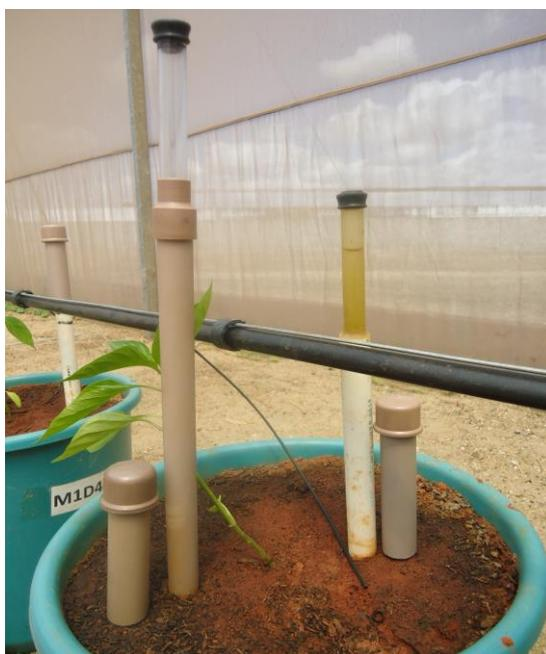
**Figura 5.** Posição do extrator da solução do solo e do tensiômetro no interior do vaso. Mossoró-RN, 2012.
