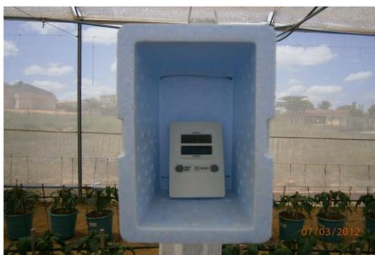
**Figura 2.** Termohigrômetro instalado no interior da casa de vegetação, Mossoró-RN,2012
