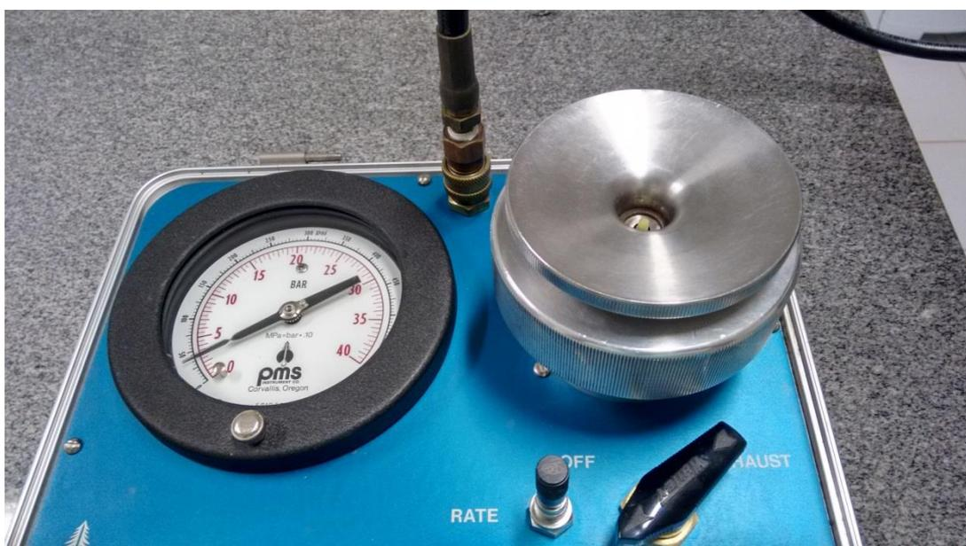
Figura 1. Câmara de pressão utilizada na avaliação de potencial hídrico das mudas de figueira irrigadas com água salina, Mossoró-RN, UFERSA, 2017.
