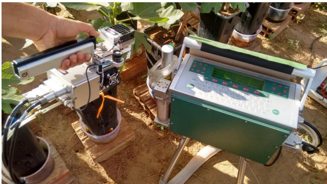
Figura 2. Medidor de fotossíntese (LICOR 6400) utilizado na avaliação de trocas gasosas das mudas de figueira irrigadas com água salina, Mossoró-RN, UFERSA, 2017.
