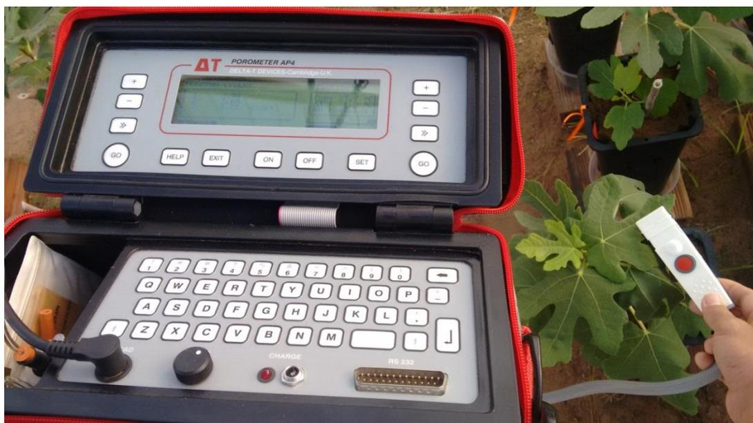
Figura 3. Porômetro de difusão (AP4) utilizado na avaliação de curva de transpiração diária das mudas de figueira irrigadas com água salina, Mossoró-RN, UFERSA, 2017.
