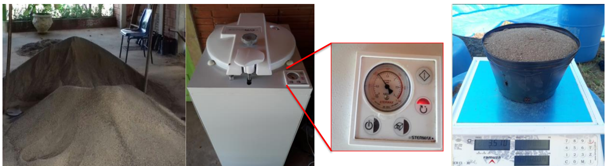
Figura 2 - Preparo autoclavagem e enchimento dos vasos com um mix de solo e areia na proporção de 1:1 (v/v), para o estabelecimento de mudas de mamoeiro, UFERSA, 2019. Fonte: Arquivo pessoal.
