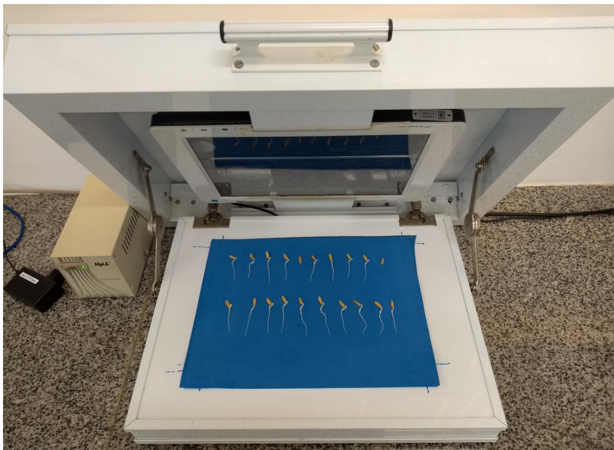
Figura 2 - Plântulas de Cucumis melo L. dispostas no interior da caixa metálica contendo um escâner HP Scanjet 200 montado de forma invertida no seu interior, sendo este acoplado ao computador com o programa Vigor-S.
