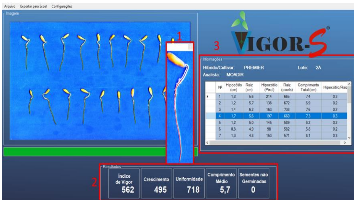
Figura 5 - Aspectos gerais da análise de plântulas de Cucumis melo L. pelo programa Vigor-S. (1) Plântula de Cucumis melo L. analisada pelo Vigor-S, com destaque para o hipocótilo (cor azul) e raiz (cor vermelha); (2) Barra de resultados contendo o resumo da análise da amostra; (3) Janela de informações contendo a identificação da amostra analisada, bem como os dados individuais da análise de cada uma das vinte sementes/plântulas avaliadas.
