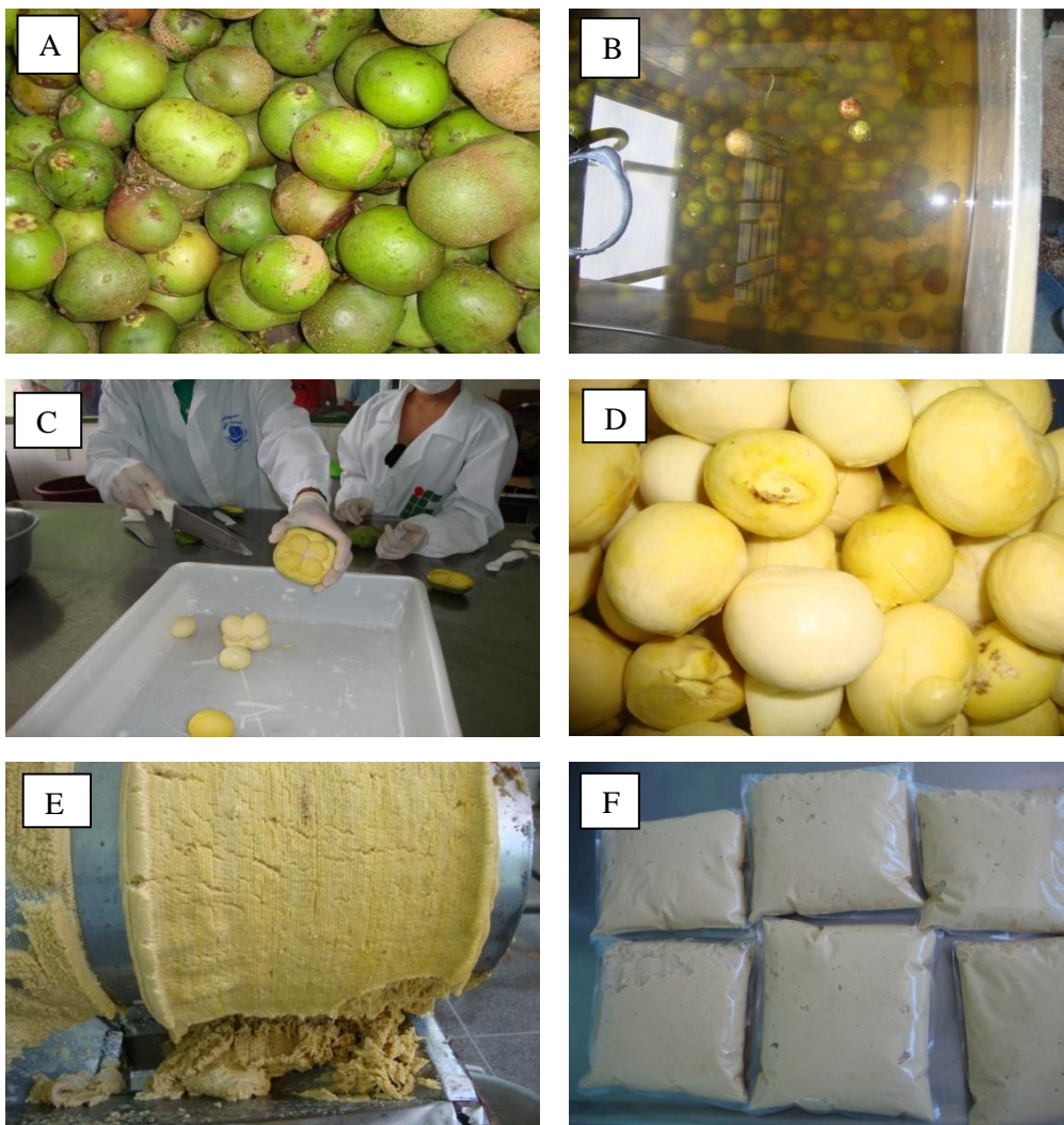
Figura 32 – Etapas do processamento de pasta de pequi: Frutos (A), sanitização (B), corte (C), caroço (D), despolpamento (E), polpa (F), Tratamento térmico das embalagens (G), homogeneização/Formulação/banho-maria (H), envase (I), pasta (J). ...continua...
